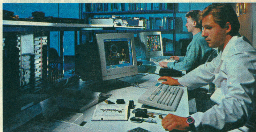
Man spricht von „Auto-Animation“, wenn wie oben (und ganz oben links) Ausgangs- und Endpunkt einer Bewegung einem Rechner eingegeben werden, und dieser dann den Laserstrahl mit bis zu 1 000 Zwischenphasen steuert. Rechts mitte: Ein zum Laser-Projektionsroboter umgebauter Industrieroboter in einem Technologie-Zentrum im österreichischen Hallein.
