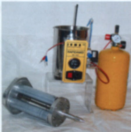
Mit dem JUMA Rapidamid Vakuum-Gießmodul können Formen- und Modellbauer aus einer Doppel-Kartusche mit gebrauchsfertig vorformuliertem Rohmaterial rasch verschiedene thermoplastische Funktionsteile ohne großen Aufwand herstellen. (Foto: JUMA)
