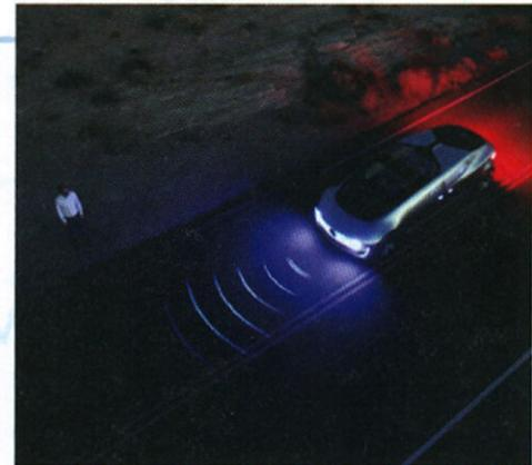
*Ein im Mercedes-Stern integrierter, hochgradig miniaturisierter Laserprojektor projiziert bei der Fahrzeugpräsentation in Las Vegas einen Zebrastrreifen auf die Fahrbahn. (Foto: LOBO)*
